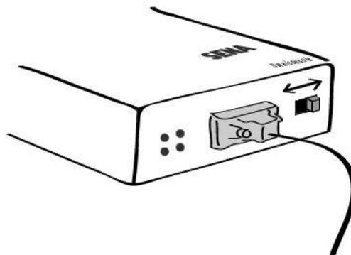
그림 2-13 PS110에 시스템 콘솔 케이블을 연결하기
