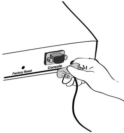
그림 2-14 PS410에 시스템 콘솔 케이블을 연결하기
