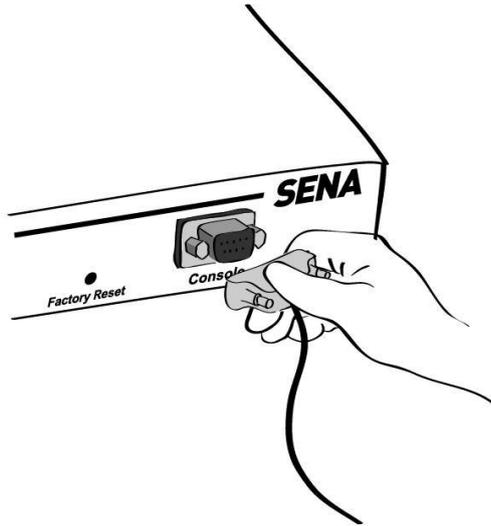
그림 2-15 PS810에 시스템 콘솔 케이블을 연결하기
