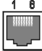
그림 A-1 RJ45 커넥터의 핀 배치
