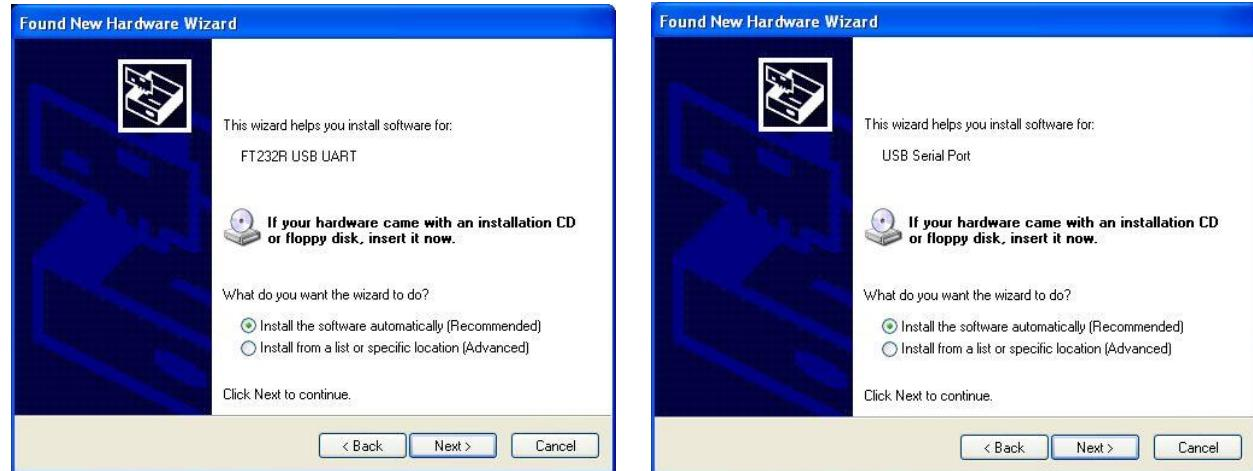
Figure 2-2 USB 드라이버 설치
