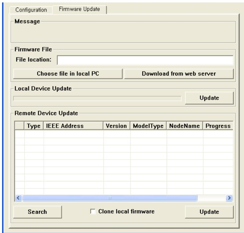
그림 2-8 ProBee Manager 펌웨어 업데이트 화면
