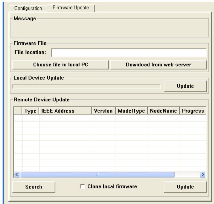
그림 2-14 ProBee Manager 펌웨어 업데이트 화면
