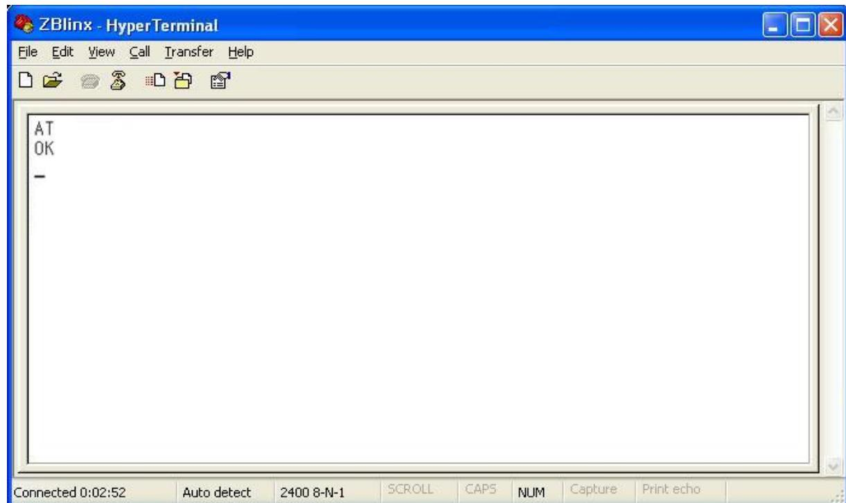
그림 2-10 AT 명령어 입력 테스트
