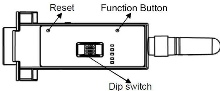
그림 2-8 ProBee-ZS10 딥 스위치
