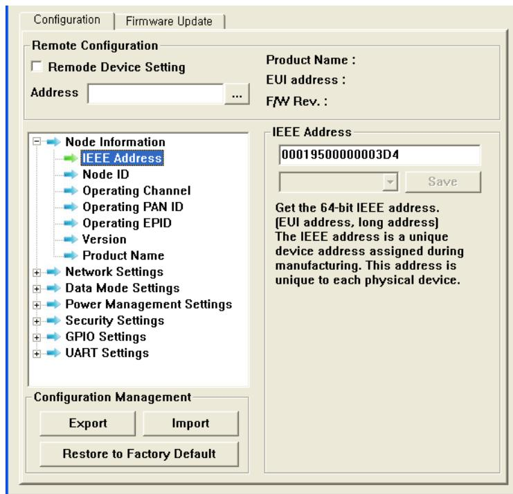
그림 2-13 ProBee Manager 설정 화면
