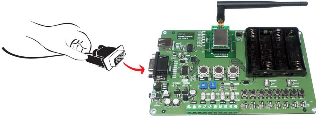
그림 2-4 시리얼 케이블 설치
