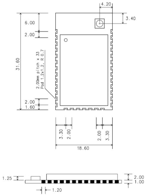
그림 12-4 ProBee-ZE20SSU 치수
