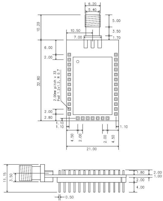
그림 12-2 ProBee-ZE20SDS 치수
