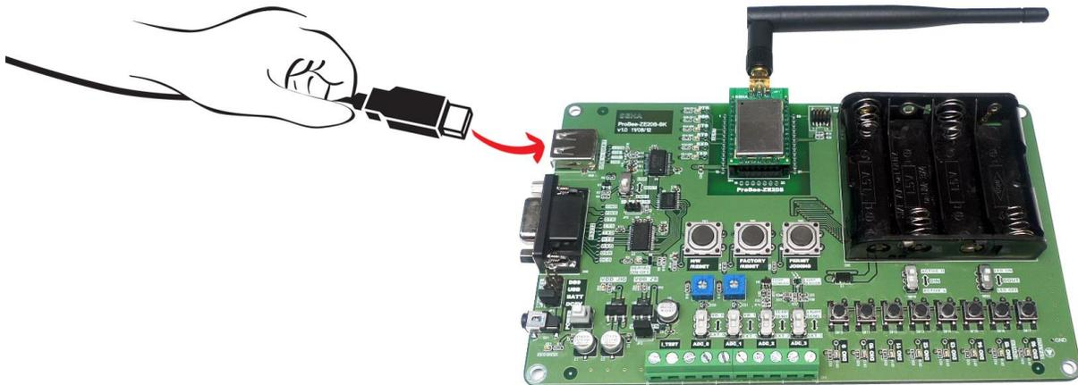
그림 2-5 USB 케이블 설치
