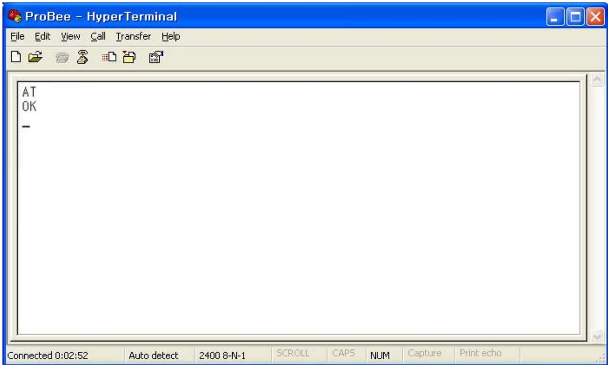
그림 2-9 AT 명령어 입력 테스트
