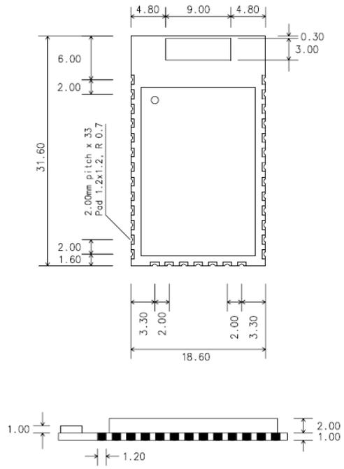
그림 12-5 ProBee-ZE20SSC 치수
