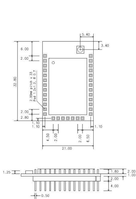
그림 12-1 ProBee-ZE20SDU 치수
