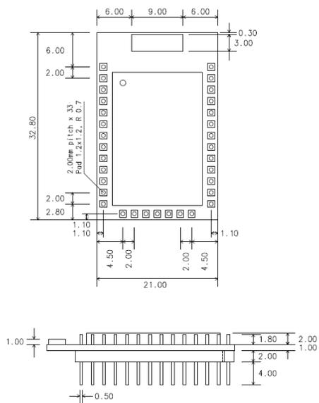
그림 12-3 ProBee-ZE20SDC 치수
