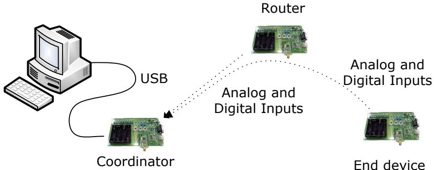
그림 6-3 예제 #1: 코디네이터 1개, 라우터 1개 및 엔드 디바이스 1개
