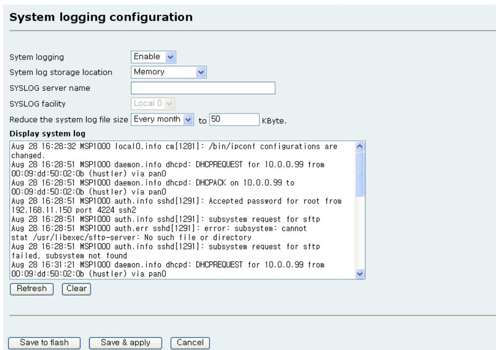
그림 8-2 시스템 로깅 설정
