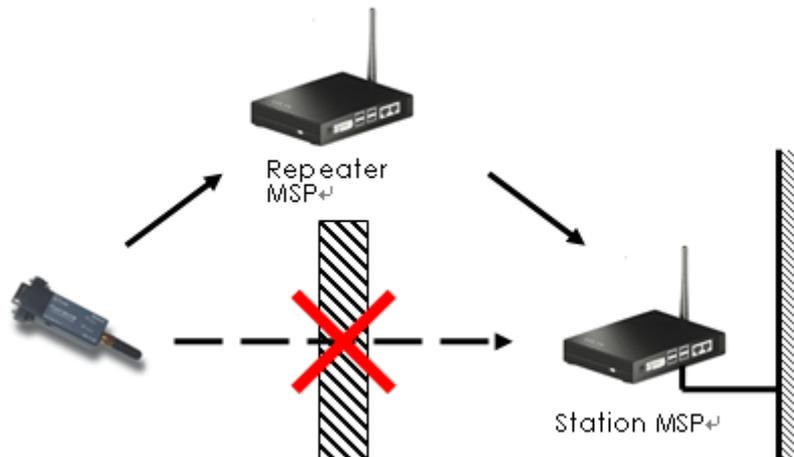
그림 4-2 Repeater를 이용한 블루투스 통신
