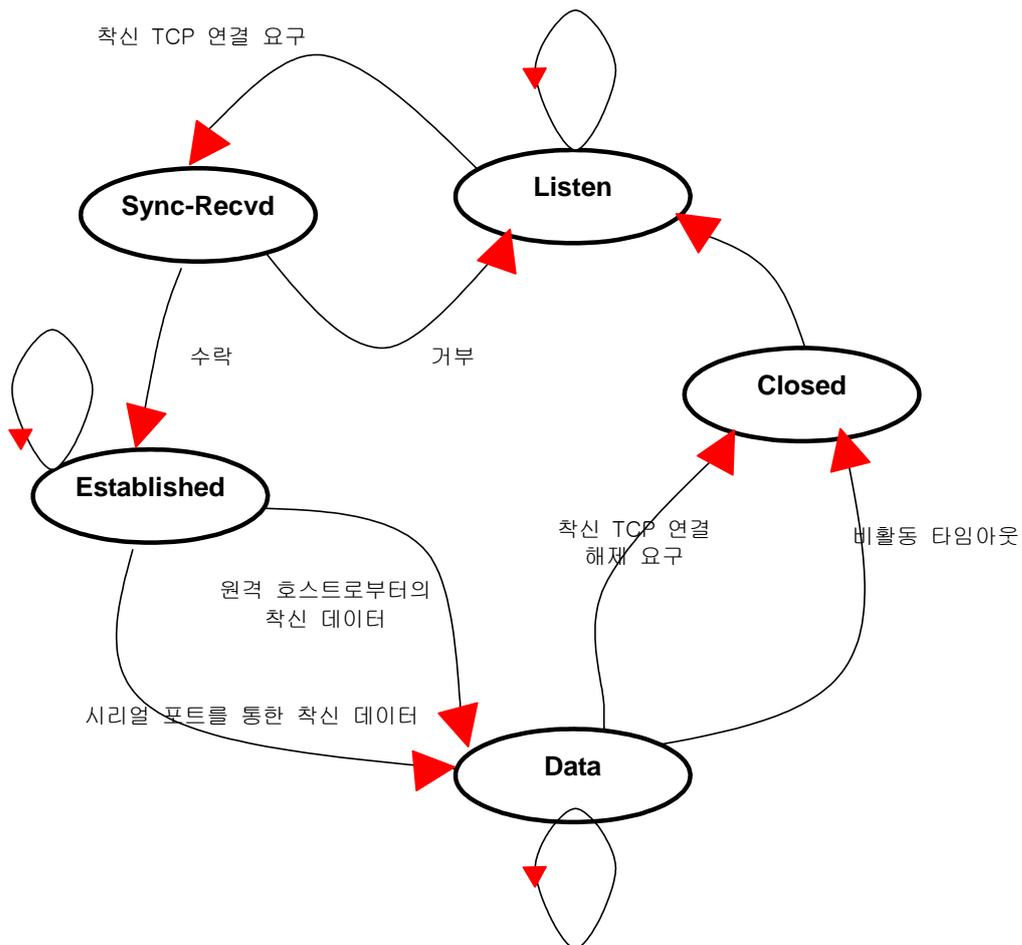
그림 4-1 TCP 서버 모드 상태 전이도
