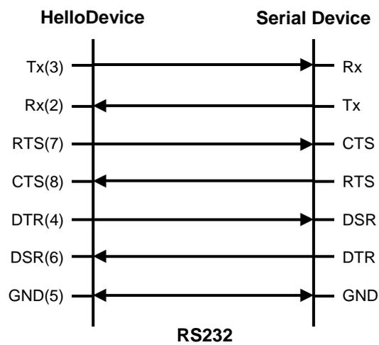
그림 A-5 RS232 wiring diagram
