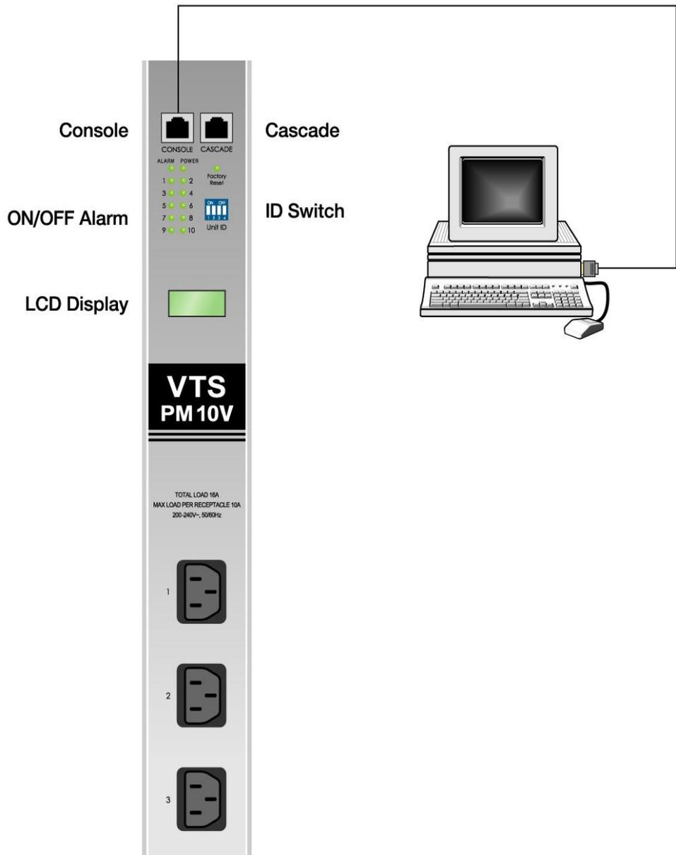
그림 오류! 지정한 스타일은 사용되지 않습니다.-4 VTS PM10V 단독형 모드 구성도
