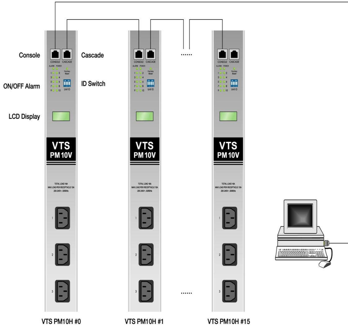
그림 오류! 지정한 스타일은 사용되지 않습니다.-6 VTS PM10V 직렬형 모드(Cascading mode) 구성도
