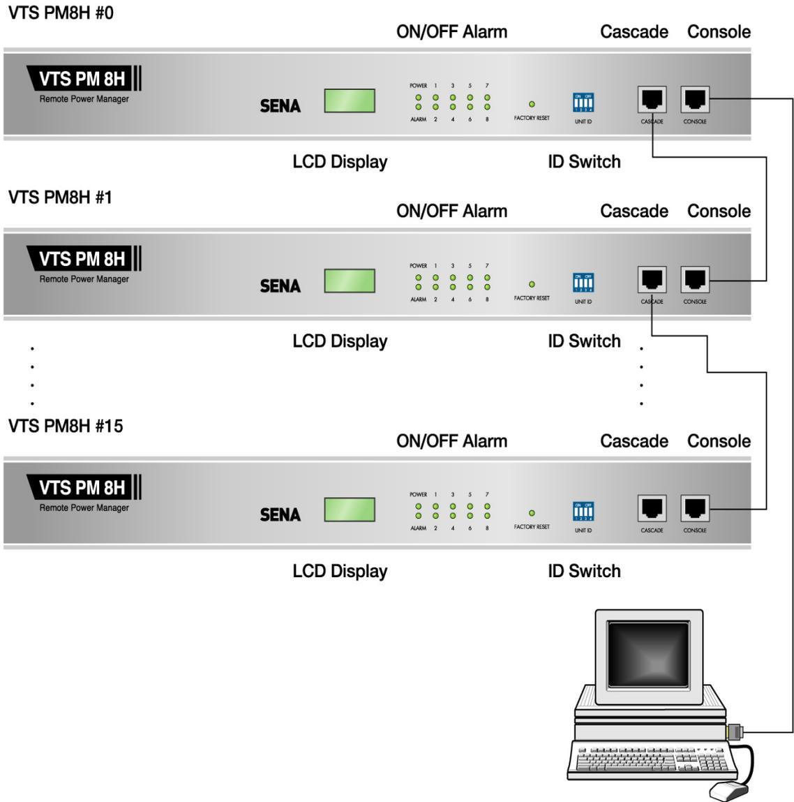
그림 오류! 지정한 스타일은 사용되지 않습니다.-5 VTS PM8H 직렬형 모드(Cascading mode) 구성도
