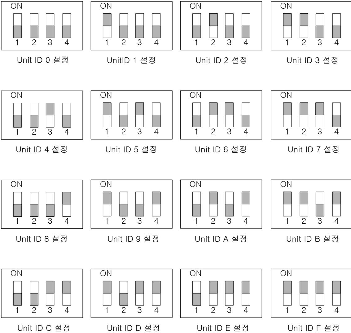
그림 A-3: ID Switch 설정 방법
