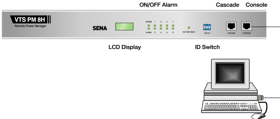
그림 오류! 지정한 스타일은 사용되지 않습니다.-3 VTS PM8H 단독형 모드 구성도
