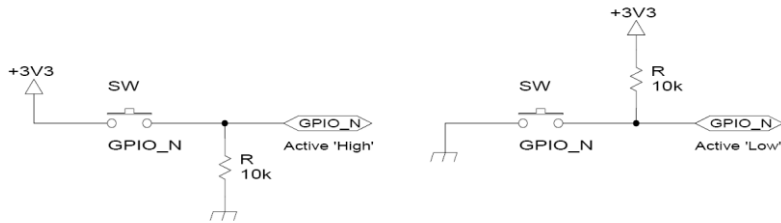
그림 5-5 GPIO 스위치 입력
