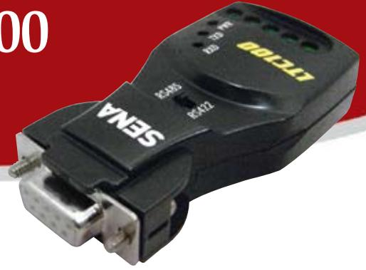
**LTC100** 은 RS232 신호를 RS422 또는 RS485 신호로 변환해 주는 컨버터입니다. 이 제품은 기존의 RS232 장비에 RS422/RS485 통신의 장점을 적용할 수 있는 효과적인 솔루션입니다. 별도의 소프트웨어를 설치할 필요 없이 바로 사용 가능한 이 제품은 DIP 스위치 조작으로 쉽게 RS422 또는 RS485를 선택할 수 있어 사용이 간편합니다. 또한 PC의 시리얼 COM 포트와 호환되기 때문에 기존의 프로그램의 변형 없이 실행할 수 있습니다.
