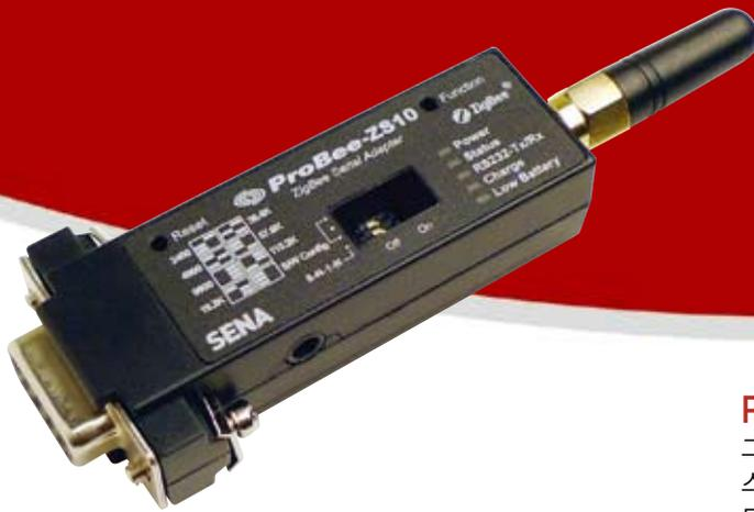
**ProBee-ZS10**은 지그비 코어와 라디오/안테나 회로를 내장한 지그비 RS232 시리얼 어댑터입니다. ZS10 시리얼 어댑터는 홈 자동화나 스마트 에너지의 요구 사항을 준수하기 위하여 저전력, 저비용으로 설계 되었으며 최신 지그비 프로 기준을 따름으로서 최대한의 호환성을 유지 했습니다. ZS10은 다양한 응용 분야에서 높은 성능과 안정적인 데이터 송수신을 제공합니다.
